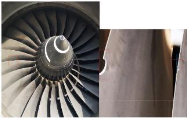
Fan blades damage
